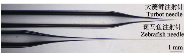
图1 大菱鲆和斑马鱼胚胎显微注射玻璃针的比较
